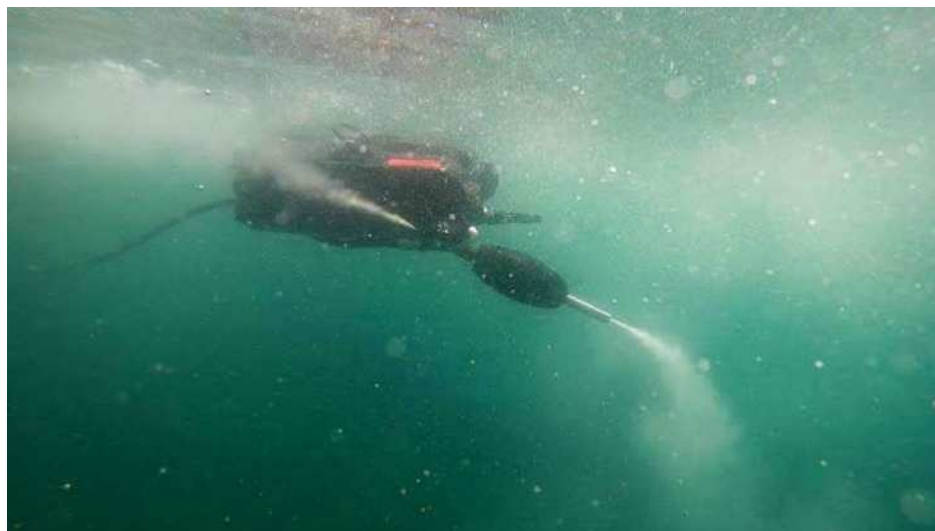
図1 高圧洗浄機を搭載した水中ドローン(参考文献：水中ドローンビジネスの教科書)
