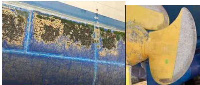
図3 前回入渠工事時の汚損状況（上：3D フォトグラメトリによる評価， 下左：右舷垂直部汚損状況，下右：プロペラ汚損状況）
