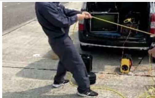
④ 大型ドローンの曳航力, 保持力の体感試験
